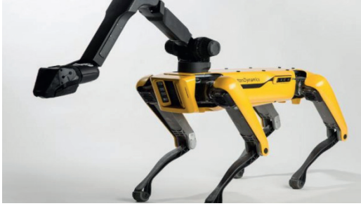
Şekil 1. Boston Dynamics Spot Cinsi Robota eklenmiş kol
